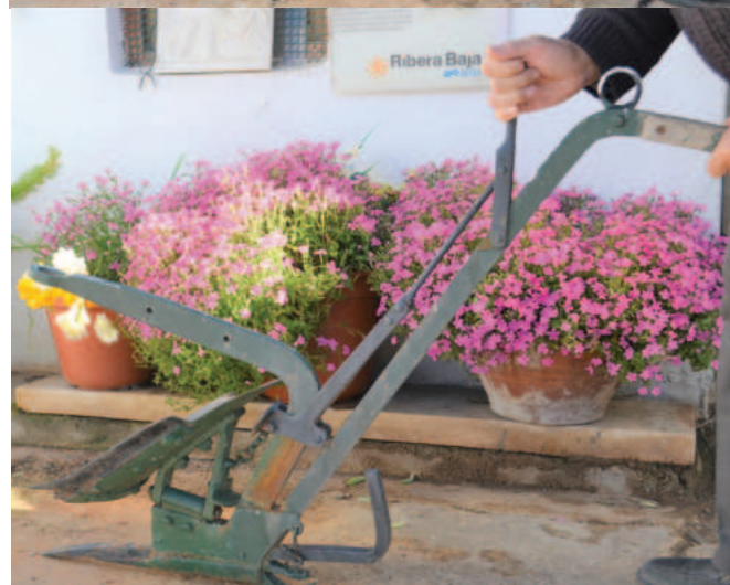
La cadena unida al brazo de elevación tira de la teja, y esta cambia de lado
